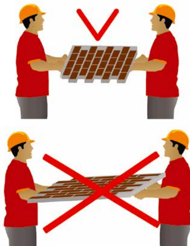
Рис. 31. Правильная и неправильная разгрузка термопанелей
