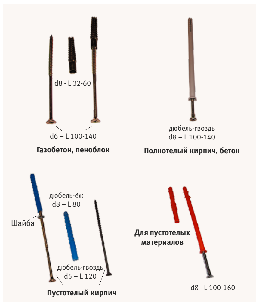
Рис. 20. Крепежные элементы для термопанелей в зависимости от материала стены
