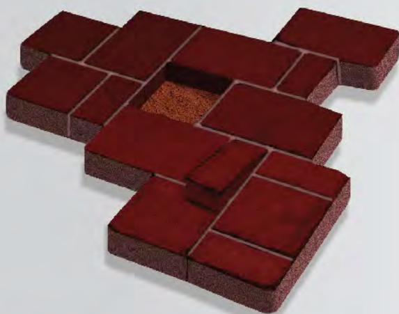
расшатывание брусчатки и западание отдельных плит
